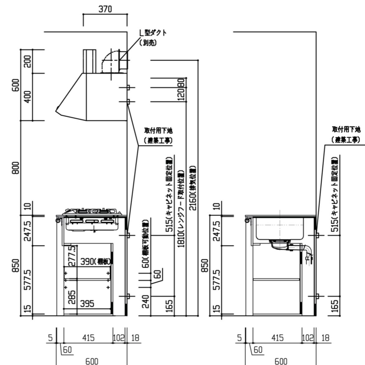
寸法図（レンジフード取付位置・水栓金具・アイアン風レール）
